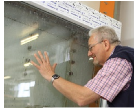
Am Prüfstand wird unter anderem die Schlagregendichtigkeit kontrolliert.
